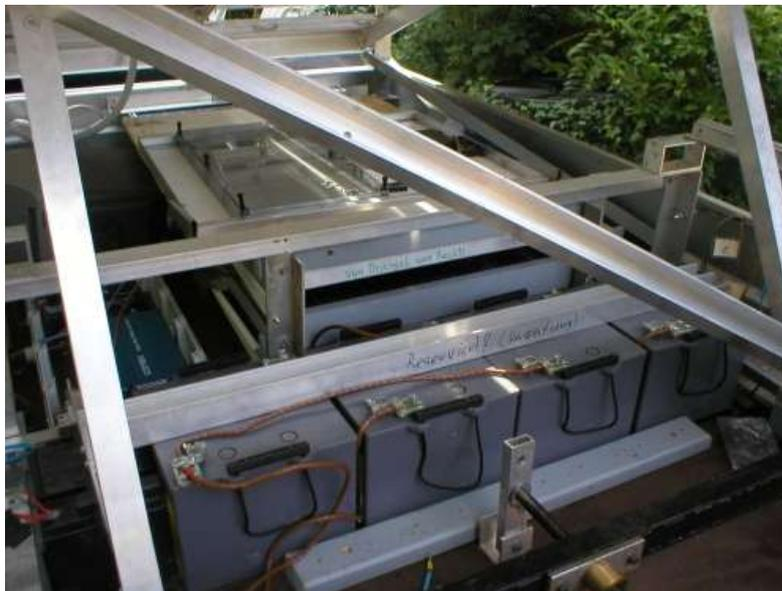
Über der Rad-Achse befinden sich 4 Stück Blei-Gel-Akkumulatoren mit je 12V/130Ah, die als Zweiereinheiten in 24V/130Ah verschaltet wurden. Die Akku-Kapazität beträgt Brutto 5200 Wh.
