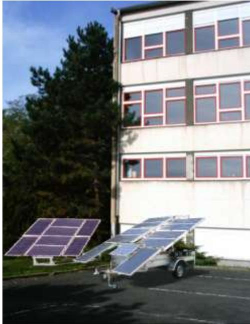
Zur Zeit wird die mobile Anlage zum Laden der Wechsel - Akku für die Elektro - Kleinrennwagen, als Stromquelle für Experimente und als Demonstrationsobjekt zur Gewinnung und Anwendung Erneuerbarer Energien verwendet.
