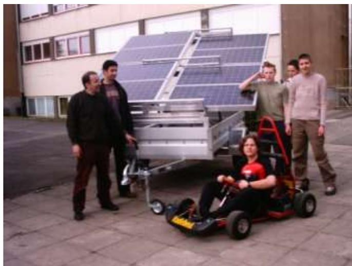
**Zur Fertigstellung** wurden ca. 120 kg Aluminiumprofile in unmittelbarer Projektumsetzung durch Dr. Schulze und die Praktikanten Leonhard König und Bachir Boudelal zu zwei unterschiedlichen Trägergestellen für Solarmodule verarbeitet.
