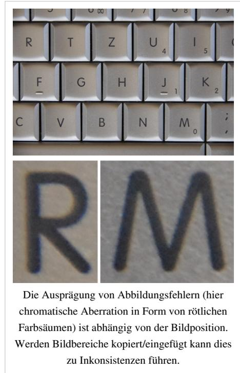
Die Ausprägung von Abbildungsfehlern (hier chromatische Aberration in Form von rötlichen Farbsäumen) ist abhängig von der Bildposition. Werden Bildbereiche kopiert/eingefügt kann dies zu Inkonsistenzen führen.
